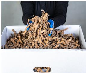
Herstellung von Kartonchips als Verpackungs- und Füllmaterial. Die Kartonchips stabilisieren die Ware im Paket, füllen Hohlräume und dämpfen Stöße – ganz ohne Plastik.
