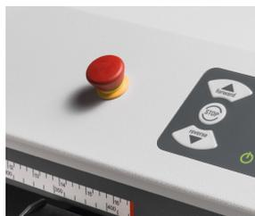
Bei Betätigung des Not-Aus-Schalters wird das Gerät sofort gestoppt.
